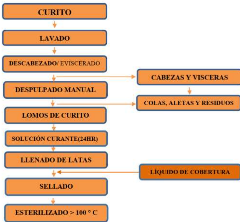
Figura 1. Esquema tecnológico para la obtención de la conserva enlatada de lomos curados de curito.
