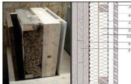
**Imagen 1:** Materiales y Detalle de fachada ventilada de CLT.
