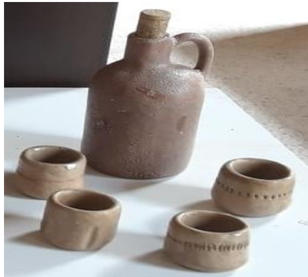
Figura 3. Cuerpo cerámico esmaltado con la variante 2 del esmalte Tipo I.
