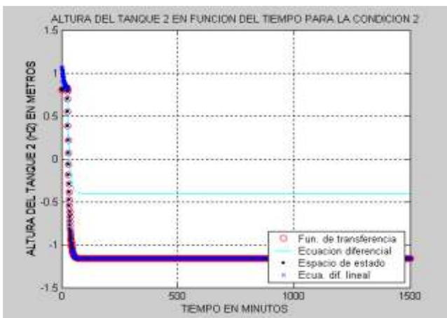
**Gráfica 2:** Altura de tanque 2 en función del tiempo, con encendido de la bomba a los 25 min
