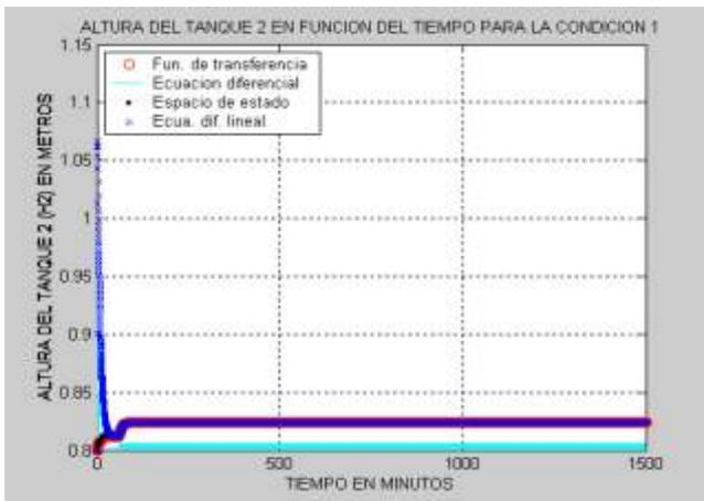
**Gráfica 1:** Altura de tanque 2 en función del tiempo, con la bomba apagada y el flujo cambia a los 60 min.
